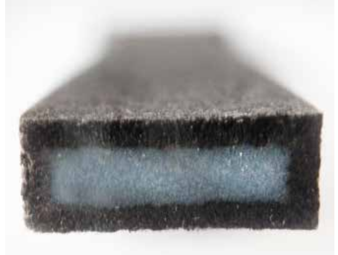
Bild 4. Zugstab aus Akromid C3 GF 30 1 natur nach 700 h bei 210 °C (© Akro-Plastic)
